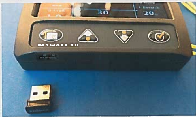
A: Das Skytraxx 3.0 besitzt vier Bedientasten. Von links nach rechts sind diese: Menütaste/Ein- bzw. Ausschalter, Navigationsfeiltaste hoch, Navigationsfeiltaste runter, Auswahlstaste. Über den USB-Anschluss kann das Gerät erweitert werden, z.B. mit einem WLAN-Dongle.
