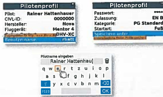
A: Im Bereich Profil definiert man die Daten von Pilot und Schirm, sowie die Zugangsdaten zu einem XC Server. Dadurch können die eigenen Flüge direkt nach der Landung im XCContest veröffentlicht werden. Buchstaben und Zahlen werden mit einer virtuellen Tastatur über das Hybrid-Motion-Verfahren eingegeben.
